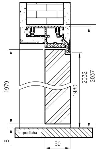
2037 - požadovaná výška montážneho otvoru
