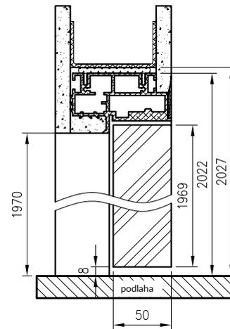
2037 - požadovaná výška montážneho otvoru
