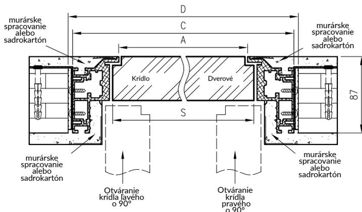
Vertikálny prierez dverí 50mm s obráteným falcom - otvárané dovnútra
