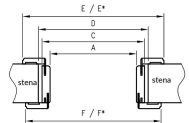
D - požadovaná šírka otvoru v mure
