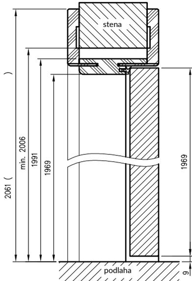
požadovaná výška otvoru v mure 2006 mm
