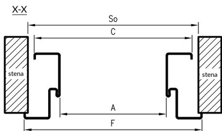
SO - šírka montážneho otvoru
